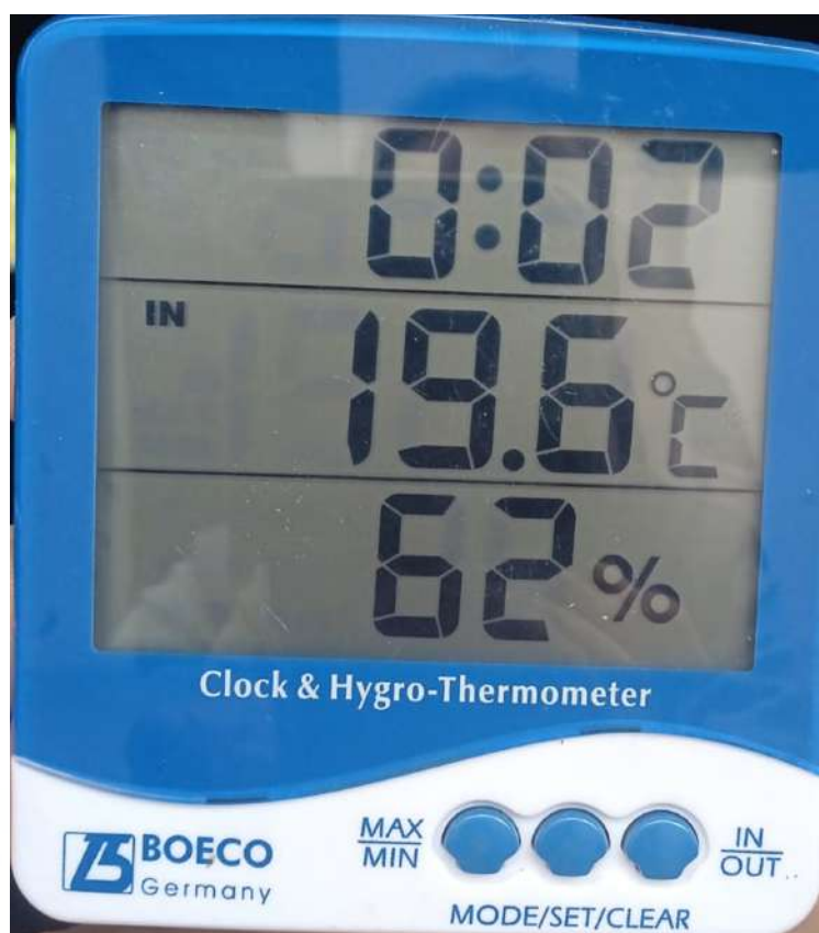
FIGURA 31. HIGRÓMETRO. FUENTE: EL AUTOR
